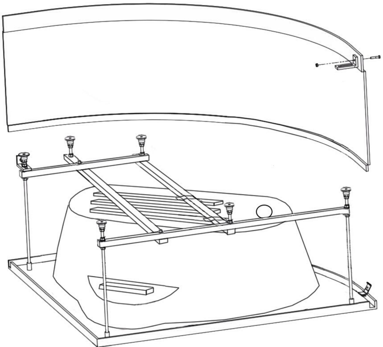
Схема монтажа каркаса и лицевого экрана ванны модели B0244A-XXX
